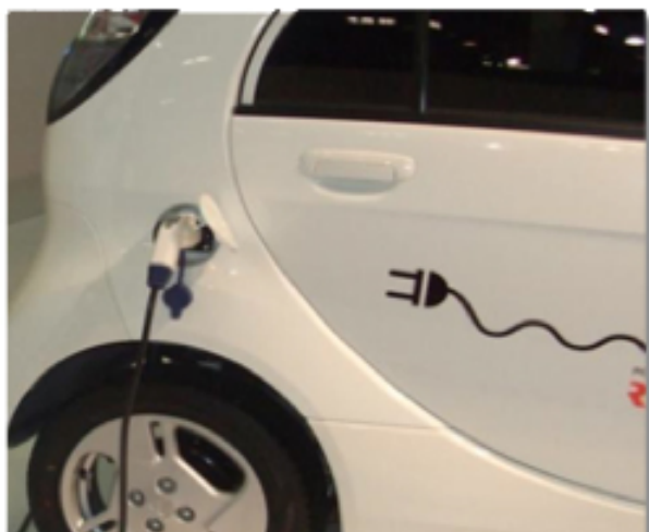
ESEMPIO DI RICARICA MODO 2
