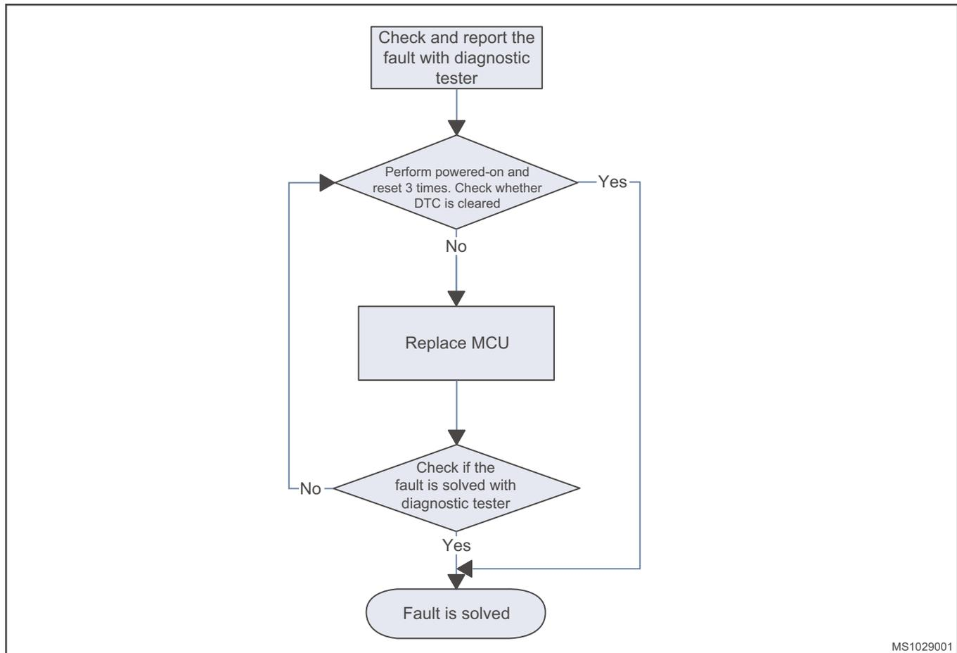
**Motor Phase Lack Fault P0A59**
