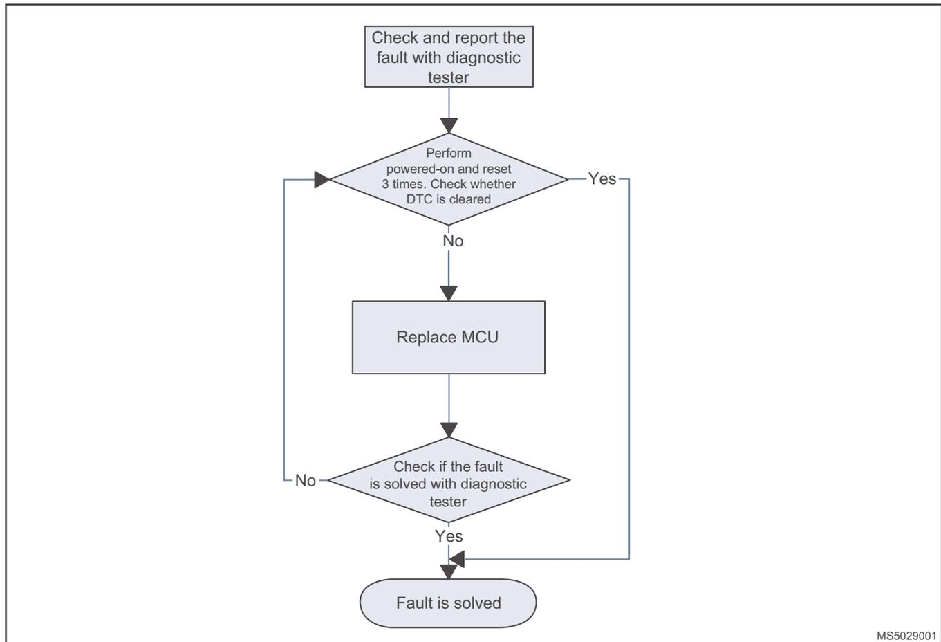
**Motor Phase Lack Fault P0A59**
