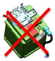
Con batteria Alta Tensione **SCARICA** e batteria 12V **SCARICA** non è possibile l'avviamento di emergenza.
