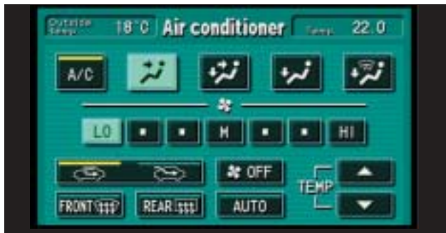
Schermo di controllo del sistema di climatizzazione nel Display Multi- informazione
