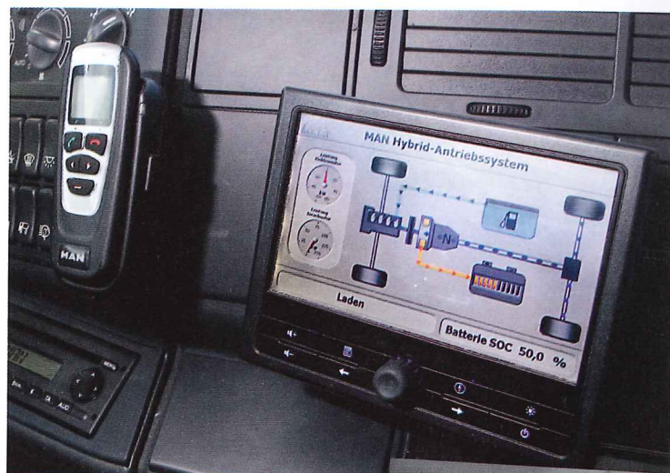
L'ibrido in pratica (in alto): ad ogni frenata la batteria agli ioni di litio accumula l'energia generata. High-Tech-Cockpit (in basso): un LCD informa costantemente il conducente sul flusso di energia nel veicolo.
