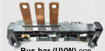
Bus bar (UVW) con sensore di corrente
