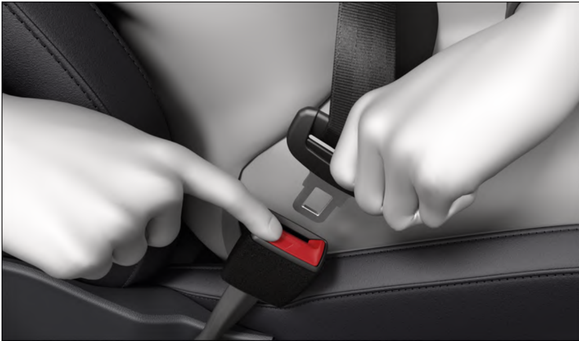
Fig. 2 Sganciamento della linguetta dal blocchetto di aggancio
