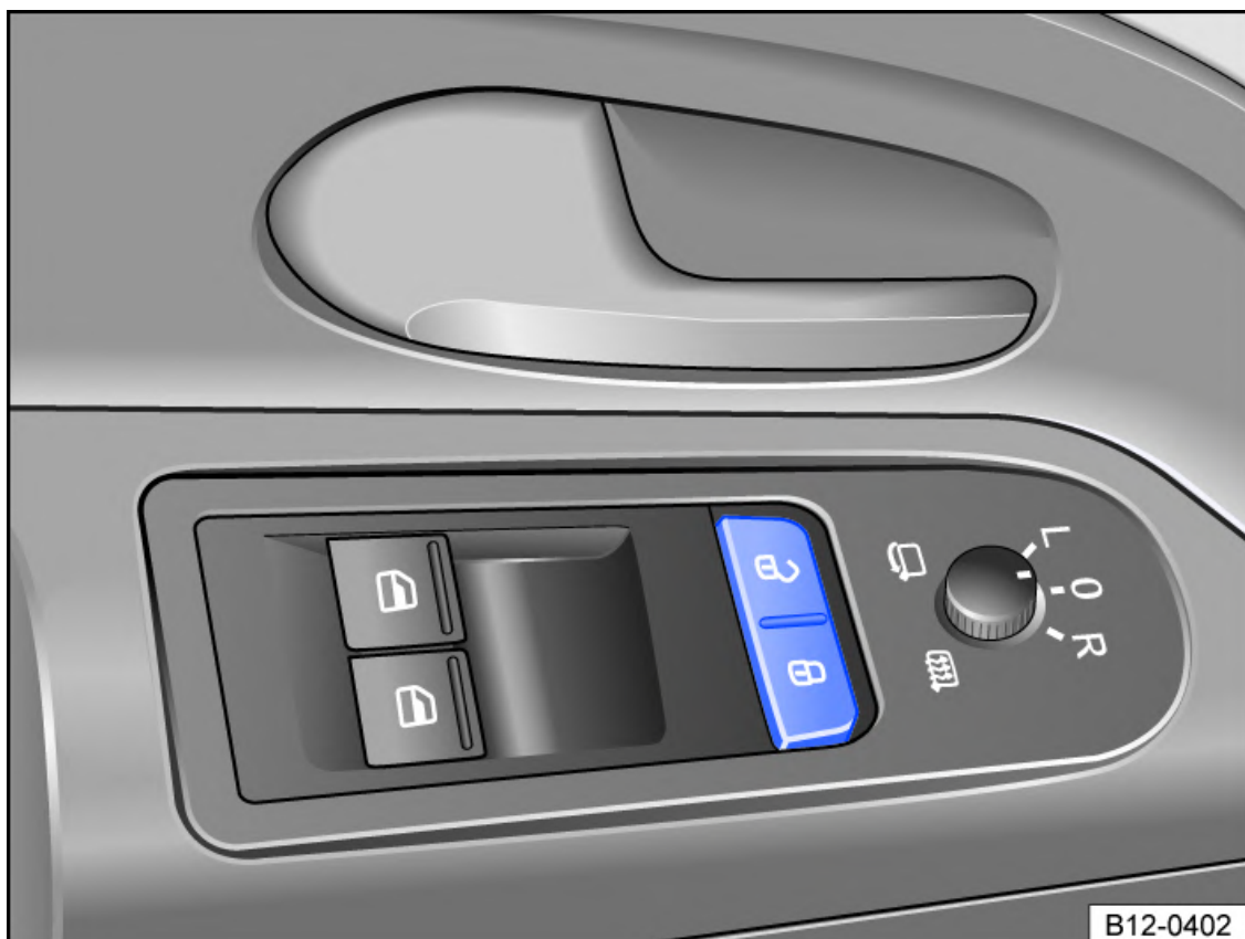
Fig. 1 Tasto della chiusura centralizzata sulla porta del conducente
