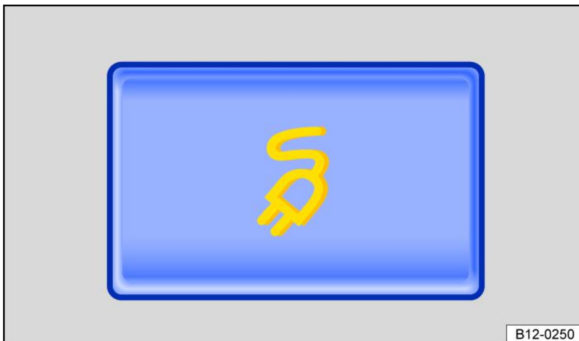
Fig. 1 Tasto della modalità di ricarica situato nella parte inferiore della console centrale
