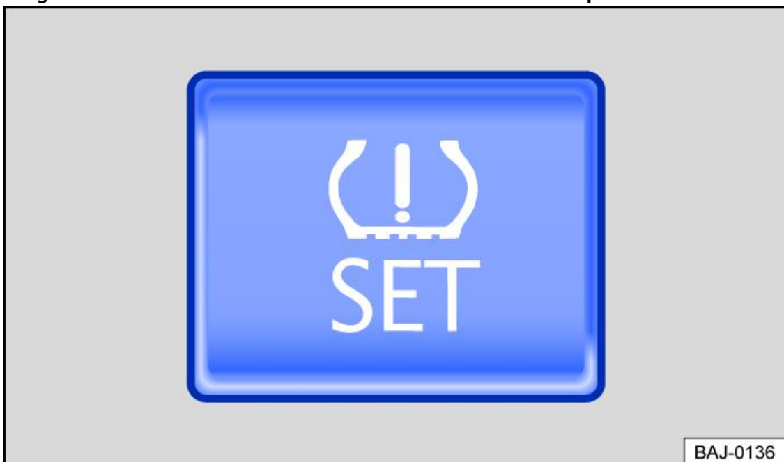
Fig. 1 Il tasto del sistema di controllo pneumatici, situato nel cassetto portaoggetti o nella console centrale
