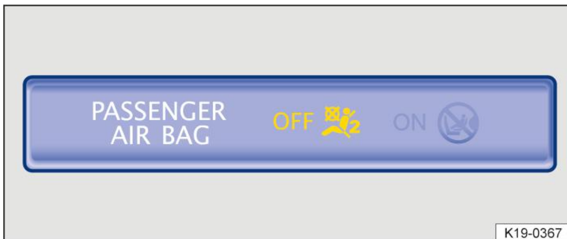
Fig. 1 Spia di segnalazione airbag frontale del passeggero disattivato, collocata sulla console del tetto (esempio)
