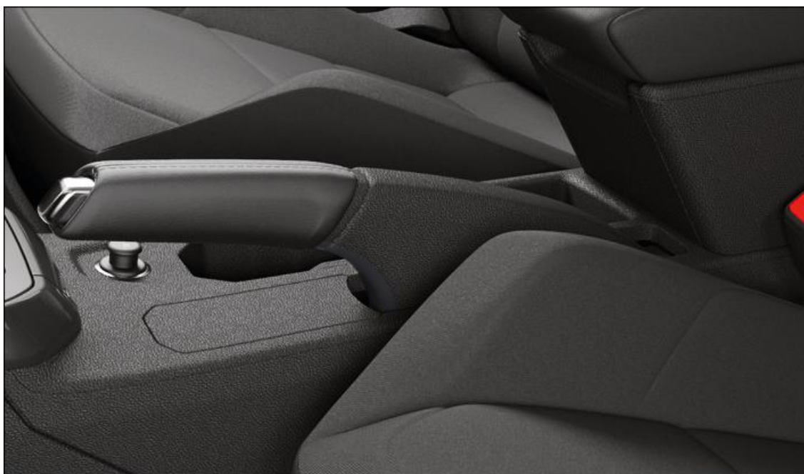
Fig. 1 Freno a mano con tasto di sbloccaggio tra i sedili anteriori (esempio)
