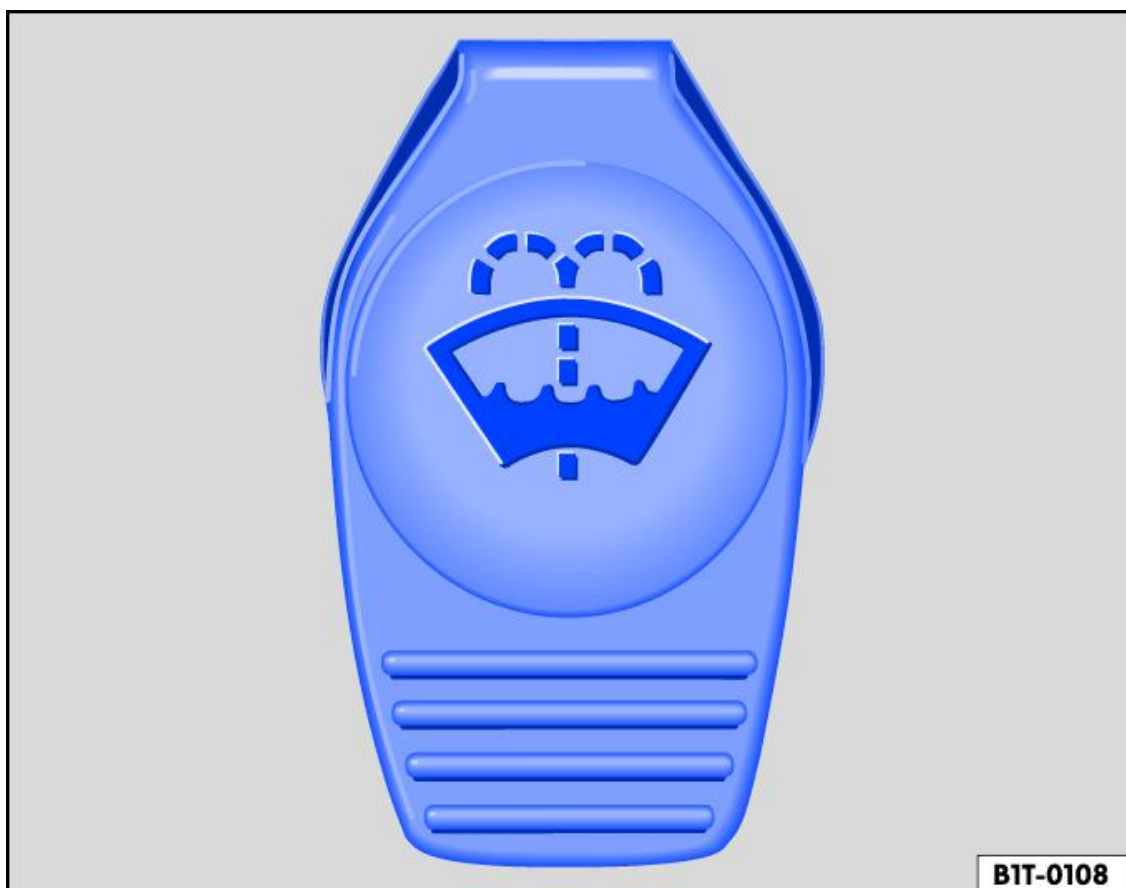
Fig. 1 Vano motore: tappo del serbatoio dell'acqua dell'impianto di lavaggio dei vetri
