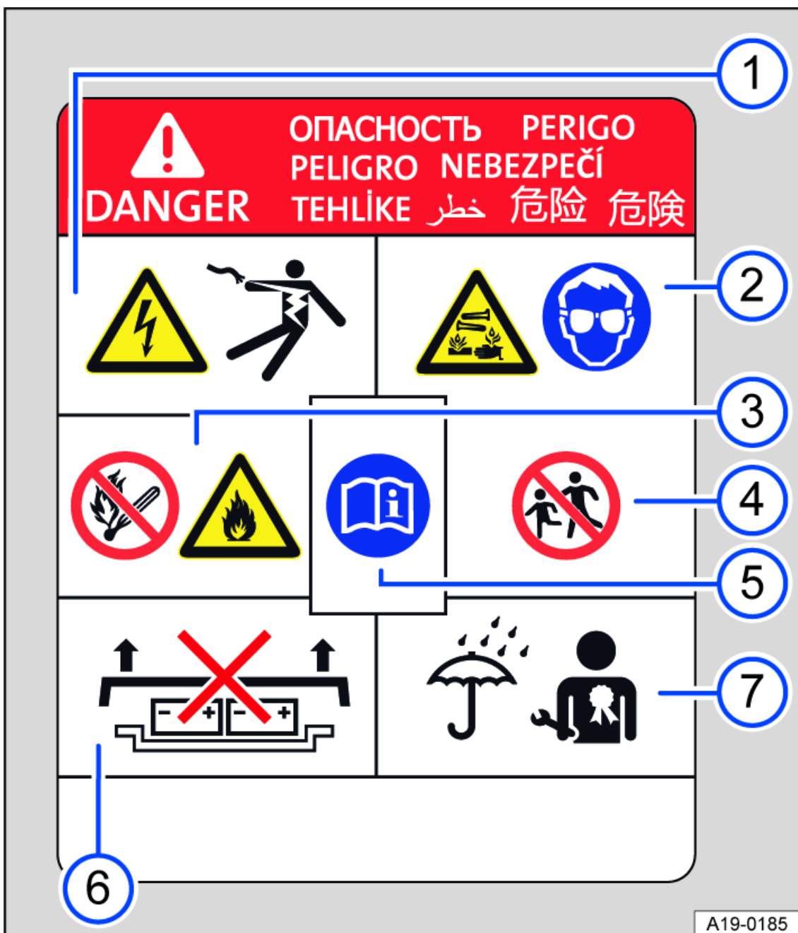
Fig. 4 Targhetta di avvertimento sulla batteria ad alto voltaggio
