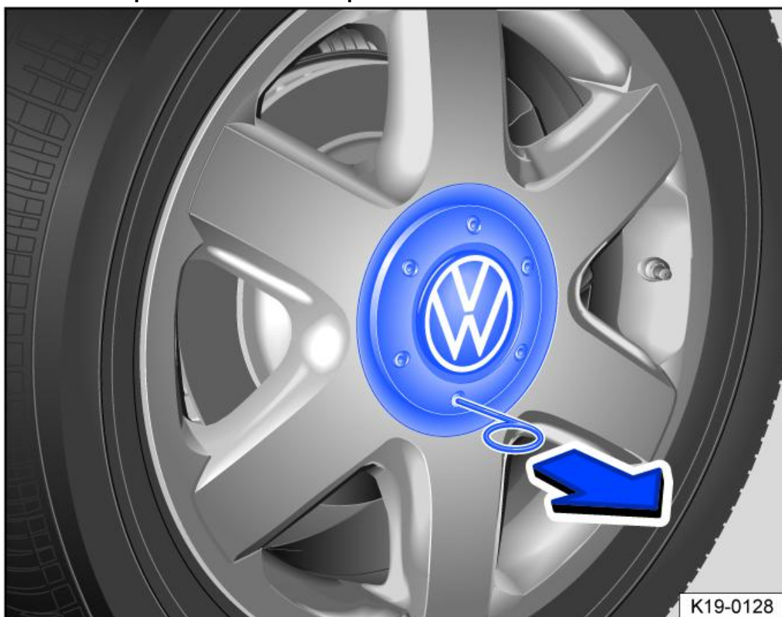
Fig. 1 Rimozione del coprimozzo
