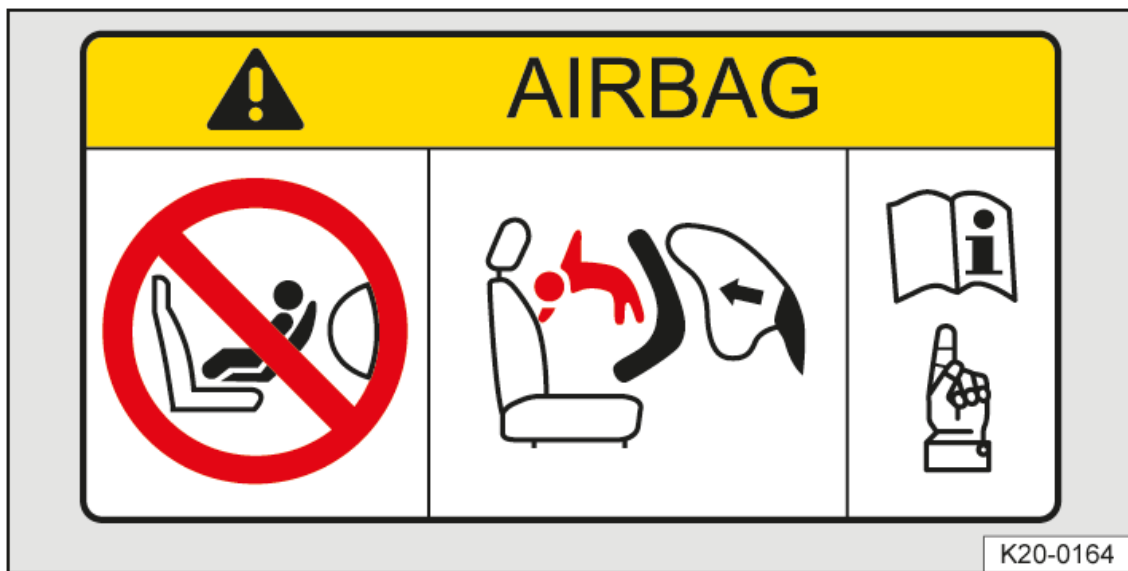
Fig. 1 Targhetta autoadesiva con avvertenze sull'airbag, collocata sull'aletta parasole
