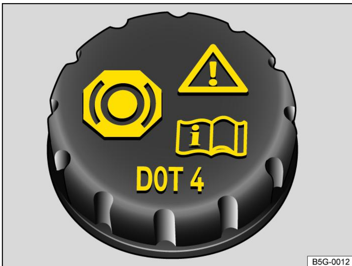
Fig. 1 Vano motore: il tappo del serbatoio del liquido dei freni
