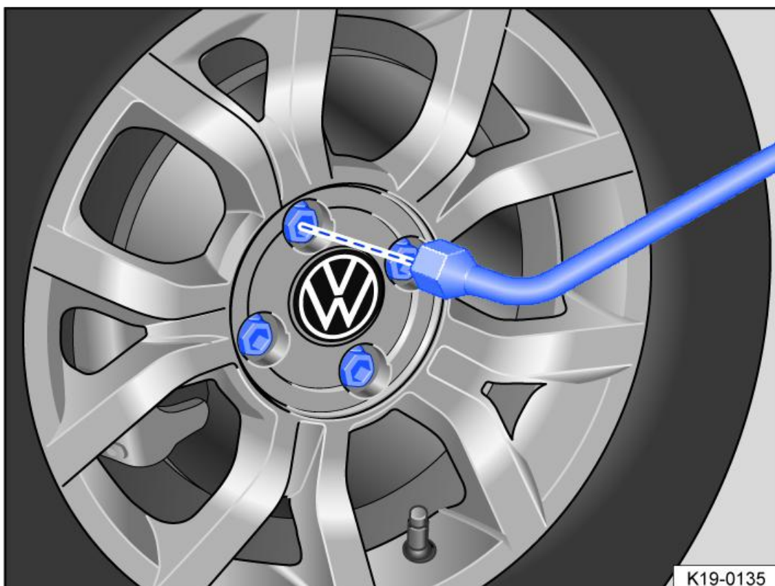
Fig. 1 Sostituzione di una ruota: estrazione delle viti della ruota per mezzo dell'apposita chiave
