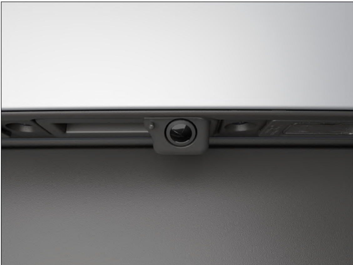
Fig. 2 Parte posteriore del veicolo: retrocamera nella maniglia (esempio)
