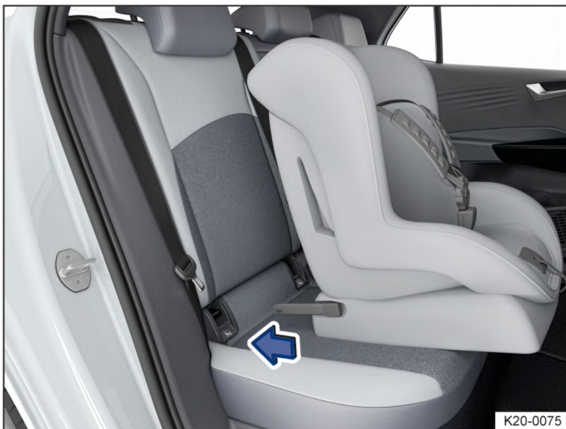
Fig. 1 Montaggio di un seggiolino con bracci di innesto (esempio)
