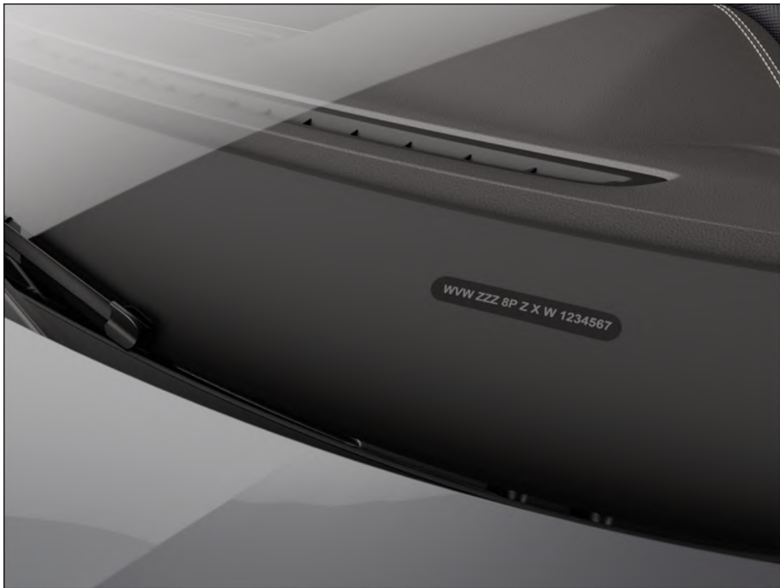
Fig. 1 Numero di identificazione del veicolo sul parabrezza
