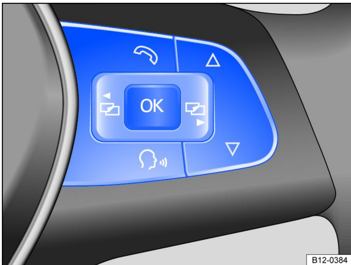
Fig. 1 Lato destro del volante multifunzionale: tasti di comando dei menu del quadro strumenti
