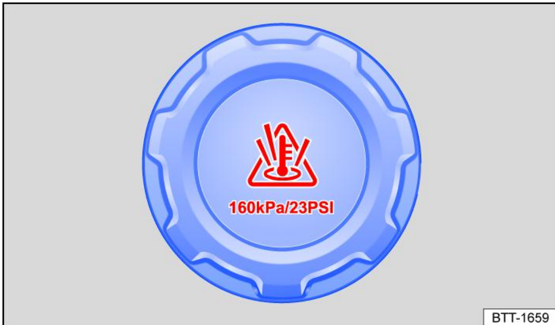
Fig. 1 Tappo del serbatoio del liquido di raffreddamento nel vano motore (esempio)
