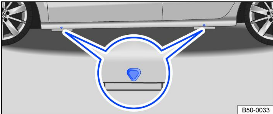
Fig. 1 Punti di applicazione del cric
