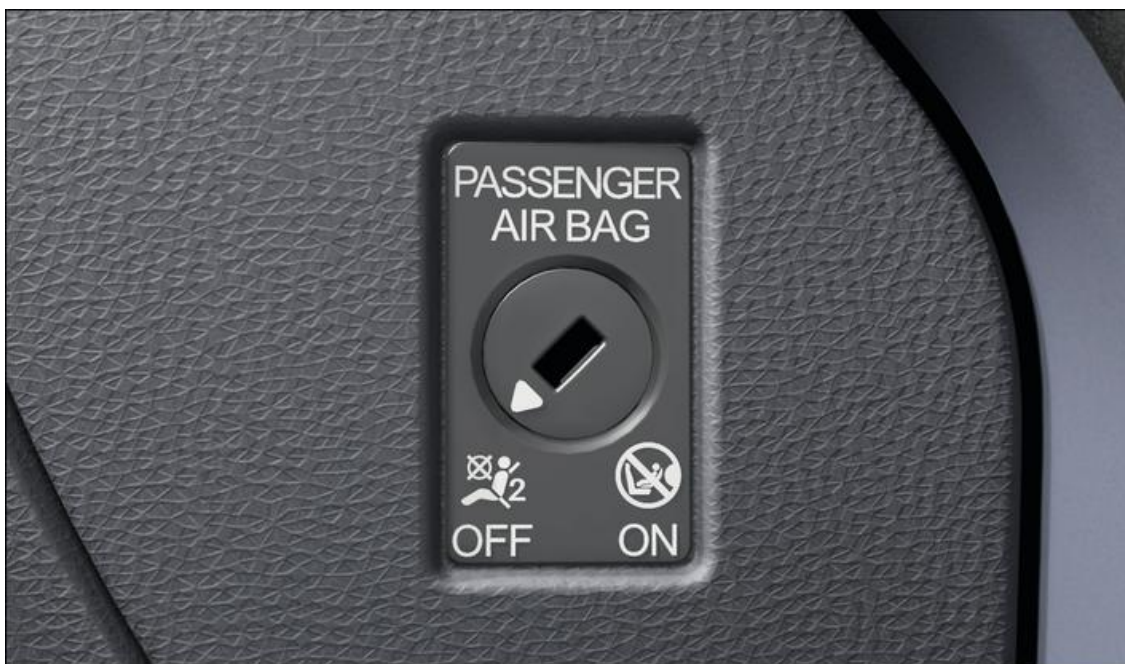
Fig. 1 Plancia lato passeggero: interruttore a chiave per la disattivazione e la riattivazione dell'airbag frontale lato passeggero
