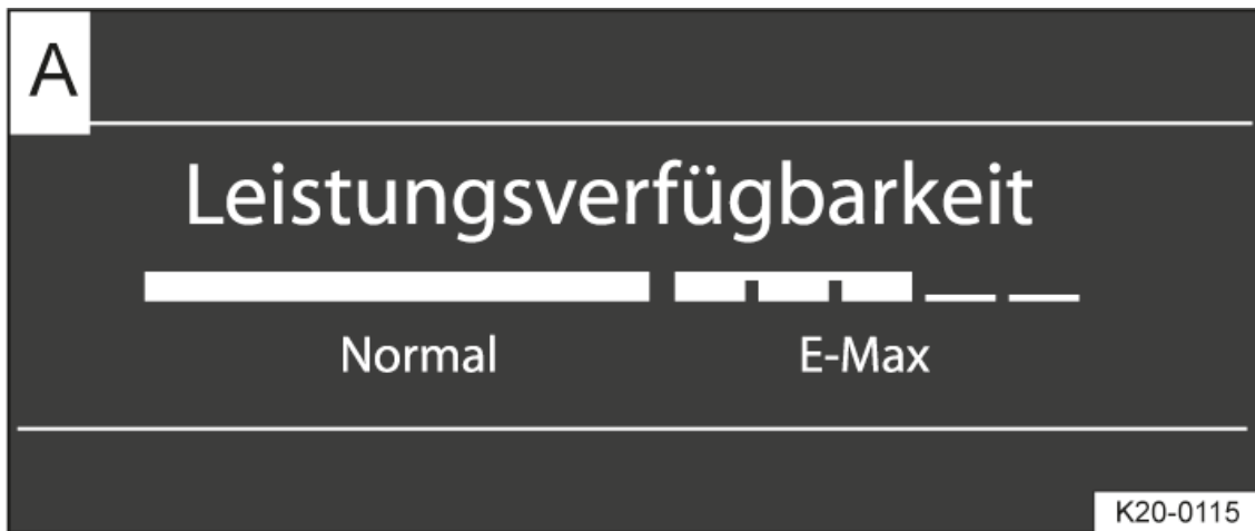
Fig. 2 Display del quadro strumenti: potenza disponibile -
