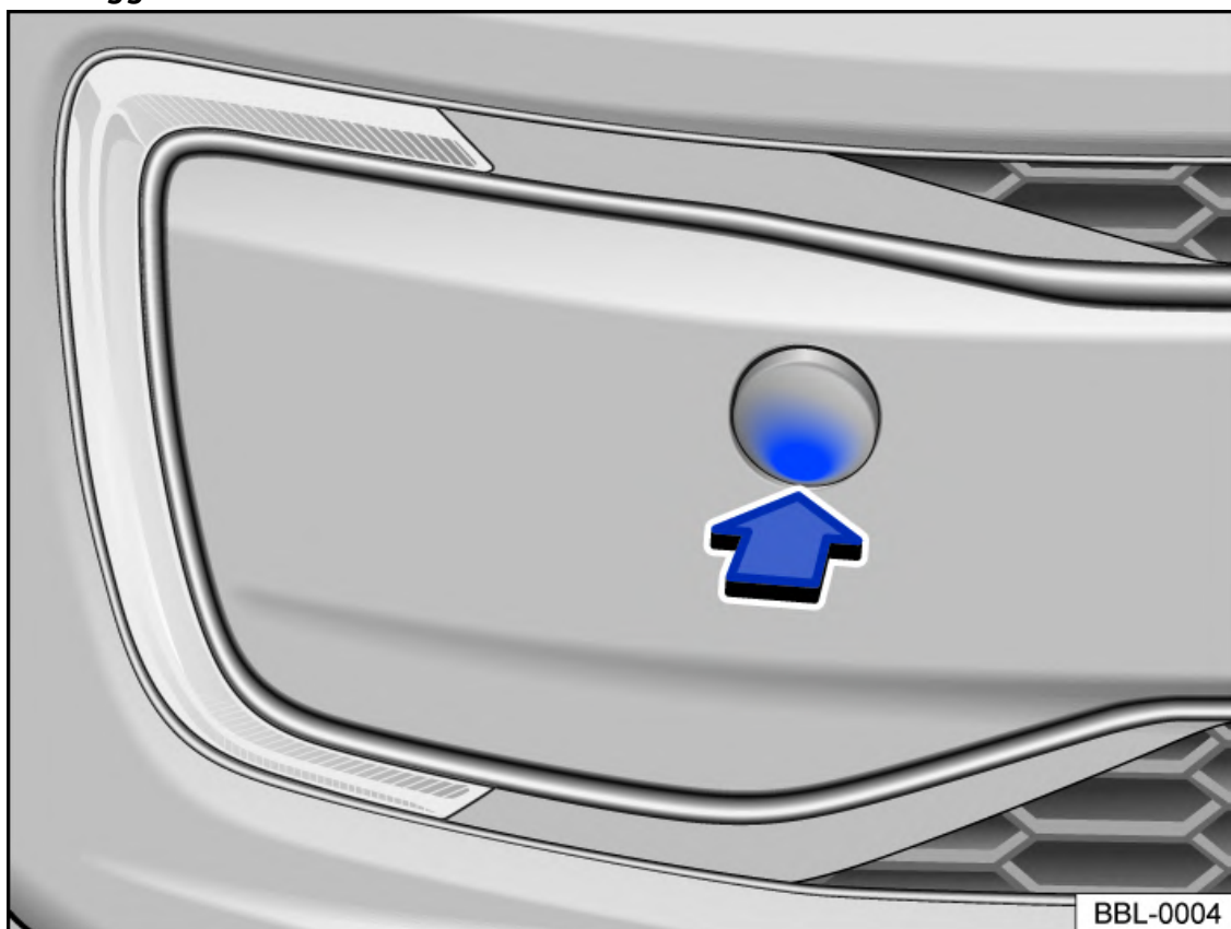
Fig. 1 Zona destra del paraurti anteriore: stacco e rimozione della copertura
