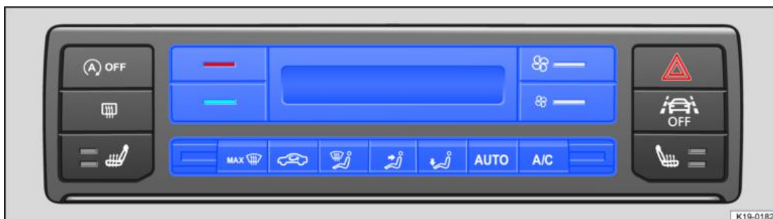
Fig. 1 Parte superiore della consolle centrale: i comandi del Climatronic
