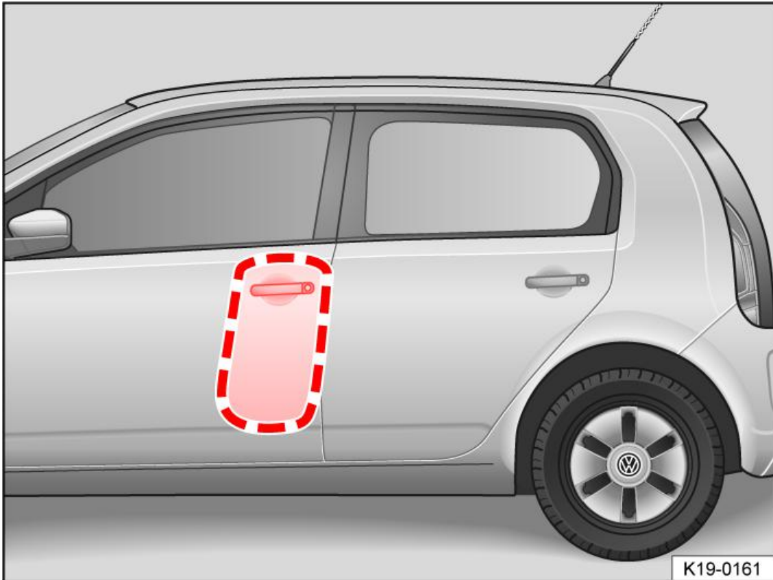
Fig. 1 Zona dell'abitacolo, lato sinistro, interessata dall'apertura dell'airbag laterale
