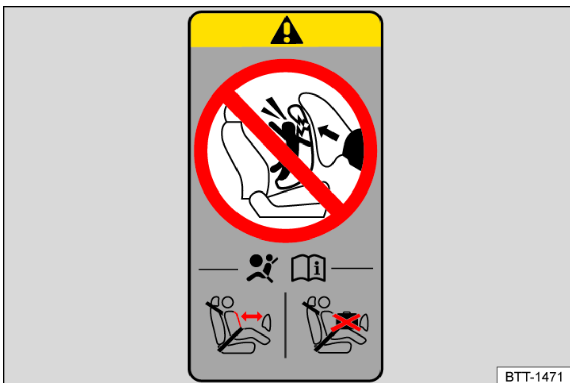
Fig. 2 Targhetta autoadesiva con avvertenze sull'airbag, collocata sul montante B
