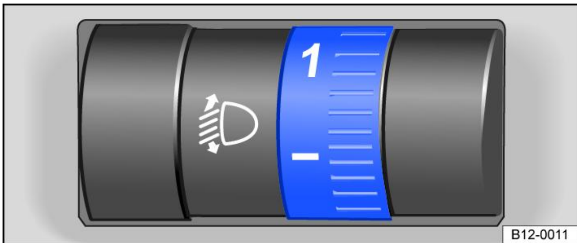
Fig. 1 La rotella del correttore assetto fari, accanto al volante
