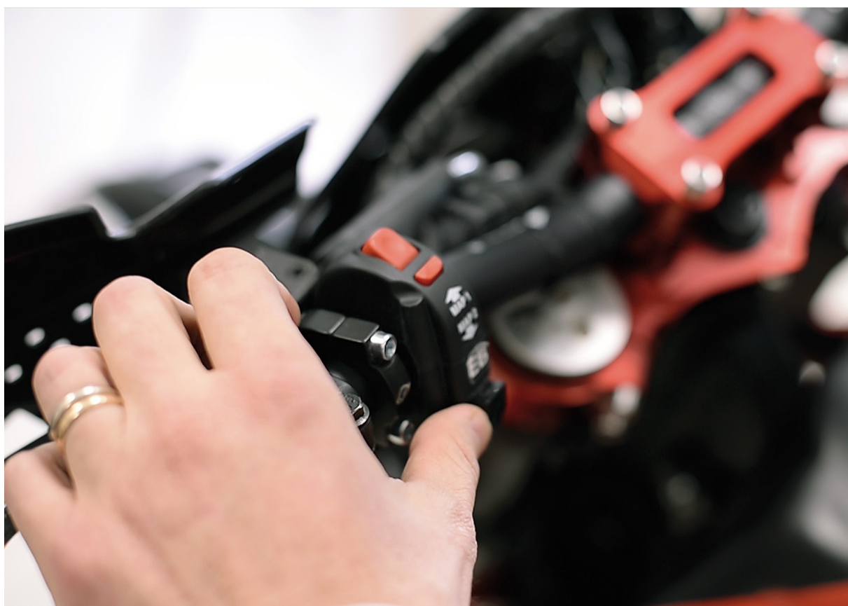
La selezione della mappa motore e dell'eventuale recupero dell'energia in frenata si imposta dal blocchetto elettrico di sinistra, dove trovano posto anche i comandi devialuci e quelli degli indicatori di direzione
