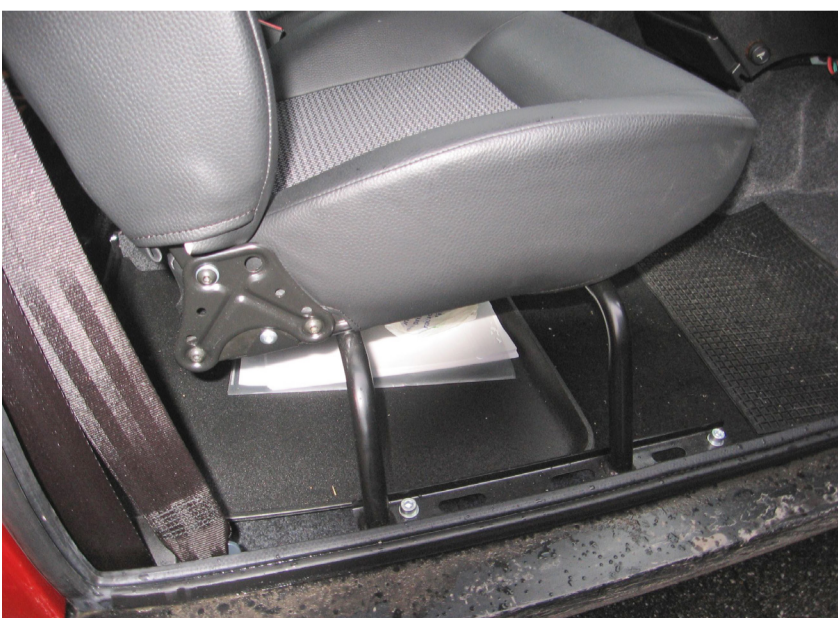
L'abitacolo. Una semplice vaschetta trasforma lo spazio sotto i sedili in un comodo vano portaoggetti
