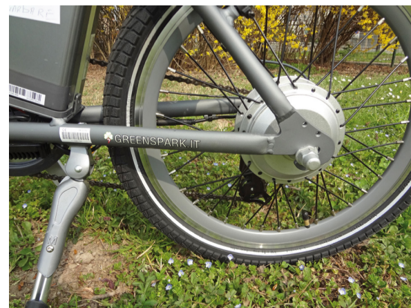
Motore con variatore interno che mantiene sempre un elevato numero di giri
