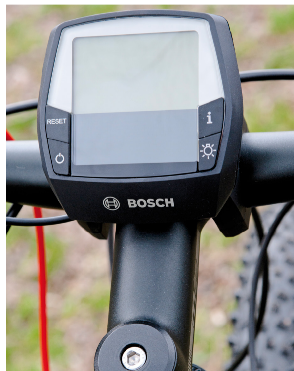
Il pannello di controllo, o più semplicemente Intuvia Display, tramite il quale si possono comandare tutte le funzioni della E-Aspect 710; livelli d'assistenza compresi
