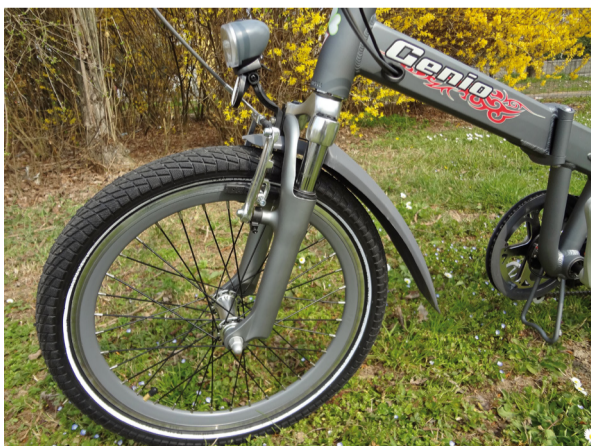
Ruote da 20" e forcella ammortizzata in alluminio, che consente una guida confortevole anche fuoristrada
